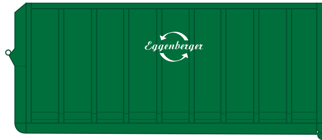
36,0 m 3 Abrollcontainer: 700 cm lang, 230 cm breit, 235 cm hoch Material: Alteisen, Bauschutt, Papier, Holz, Sperrgut, Kunststoff etc.
